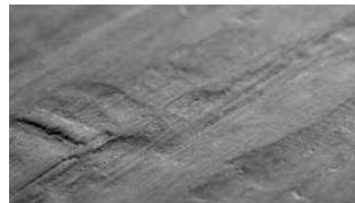
Handhobel-Holzstruktur dokumentiert die Spuren meisterlichen Handwerks
